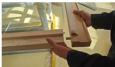
2. Pomaknite steklo čez rob, da gleda približno 1 cm ven iz spodnjega in zgornjega dela okvirja. Vstavite stranske dele okvirja.
